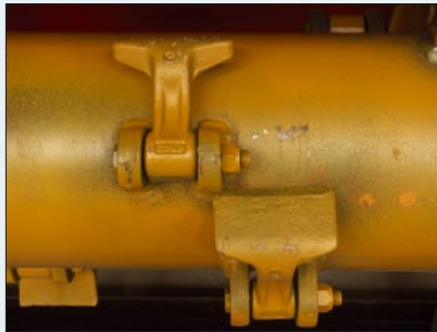
Rotorwelle mit 1300 g Schlegel (option)
