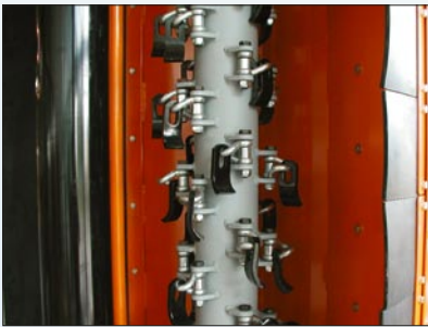
Rotorwelle mit 40 x12 Schlegel (standard)
